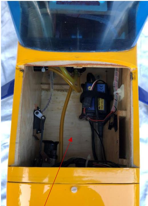
Zugang zu Motorraum (Rumpfansaugung) via Deckel (Verschluss mit Magnet) vor der Frontscheibe.
